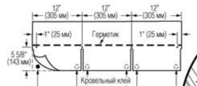
Отступить от каждого углового края 1" (25 мм) и нанести битумный клей небольшим количеством. Отмерить от точек нанесения клея 1 и 2 около 12" (305 мм) и нанести еще битумный клей в двух местах.
