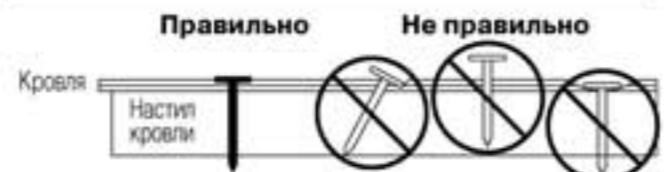
При толщине настила крыши  $3/4"$  (19 мм) или более гвоздь должен заходить в настил не менее, чем на  $3/4"$  (19 мм). При меньшей толщине настила крыши гвоздь должен проходить через настил на расстояние не менее  $1/8"$  (3,2 мм).
